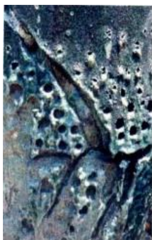
نشانه دیگر ناشی از حمله فلاکس تشکیل "سوراخ های شبیه سطح ماه" است که در پی خوردگی ناشی از مواد شیمیایی است.
