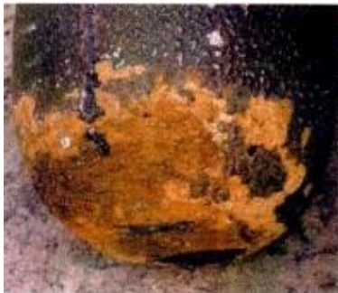
اکسیداسیون شدید به دلیل جهت نامناسب شعله
