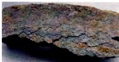
ترک خوردن لبه بالایی بوتله به دلیل جایگذاری بد در کوره که منجر به اکسید شدن گردیده است
