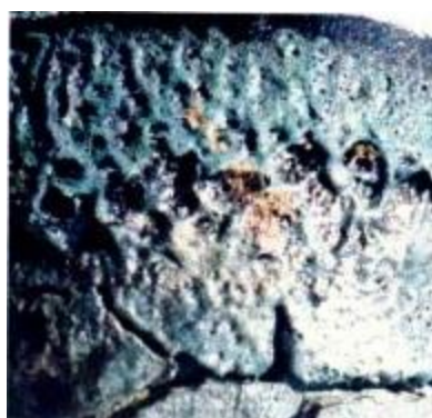
حمله فلاکس در بالای این بوتله به احتمال زیاد به این دلیل اتفاق افتاده است که مواد فلاکس بر سطح مذاب مانده اند.
